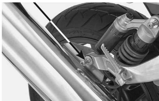
PARAFUSO/PORCA DE FIXAÇÃO DO SILENCIOSO
