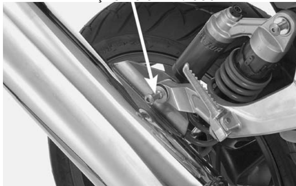
PORCA/ARRUELA/PARAFUSO DE FIXAÇÃO DO SILENCIOSO
